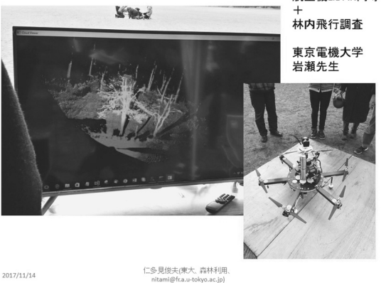
図3 レーザー装置3Dスキャンによる林況調査手法
