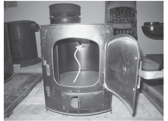
写真8 中子のない大正期の時計型（矢印はガスの流れ）
