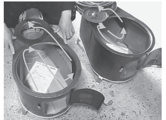
写真9 中子の大きい直販用（左）と小さいホームセンター用（右）（矢印はガスの流れ）
