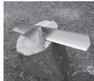
写真2 分解・組立式木竹酢液採取装置(上) 同分解・収納時(4m分)(下)
