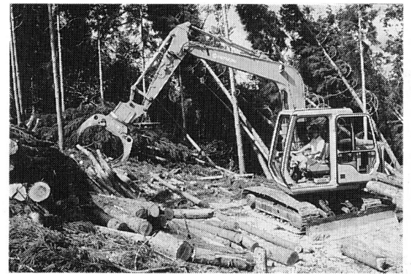
写真2 グラブプルによる作業 アタッチメントをグラブプルに換えて山工場に植積みする。作業場所は台風による被害跡地。
